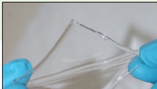
Couche élastomère étirable pour capteur de force
