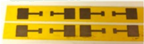
Capteurs de pression imprimés sur substrat souple
