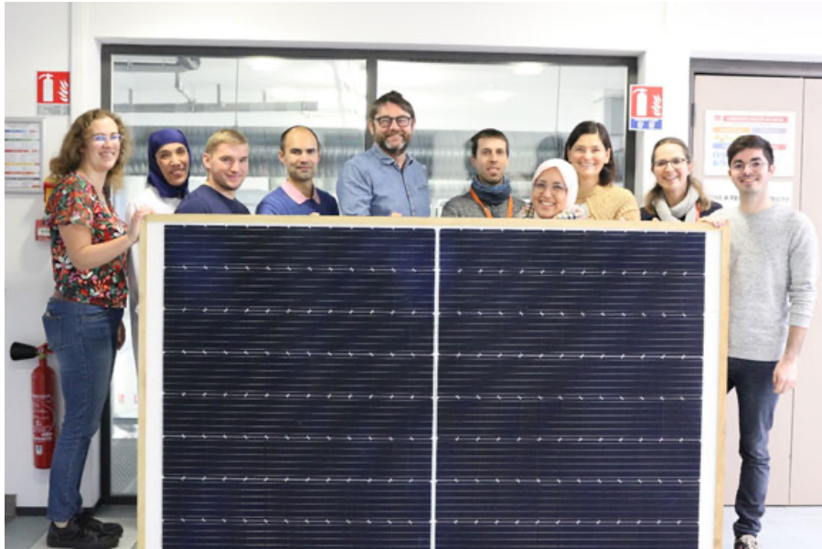
Légende : Panneau éco-conçu démonstrateur, 317 kg CO 2 éq/kWc, 566 W de puissance, fabriqué par les équipes du CEA à l'INES.
